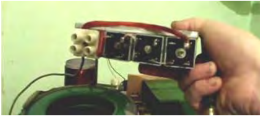
Drei 1000V Diodenbrücken verbunden sind, um eine Spannung von 6 kV auszuhalten.
