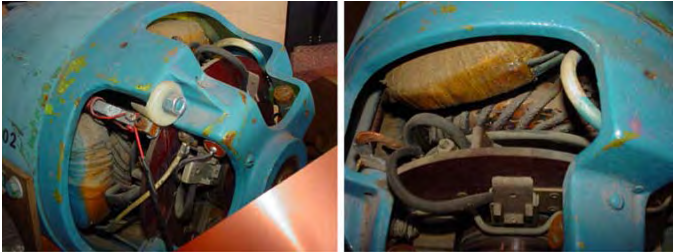
Vue arrière de la " Moteur Démarreur " Vue de l'enroulement de Stator composé et les bagues collectrices
