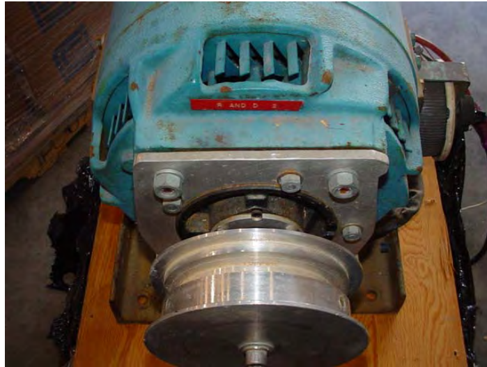
Bride adaptateur personnalisé ajouté à l'avant du moteur
