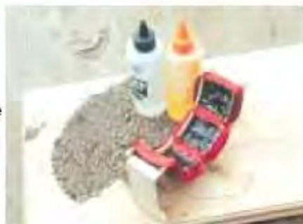
Les coeurs de stator sont remplis d'une mixture de résine époxy et de sable magnétite.
