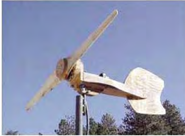
Le design suivant est pour l'installation permanente et produit plus de 300 watts dans vent de 30 m.p.h.
