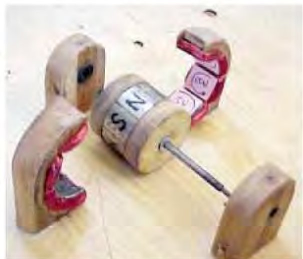
L'armature, stator et la fin bloquent prêt à se réunir dans un alternateur.
