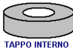
Questo tappo ha un taglio circolare buco, e questo foro è solo leggermente inferiore al diametro del cilindro interno. È sostenuto dal labbro superiore del tamburo interno ma il foro è abbastanza grande da non ostacolare il flusso di calore attraverso la parte superiore del tamburo interno. Questi tre pezzi si incastrano come questo:
