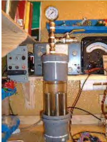
La difficoltà di creare un sistema di riscaldamento che utilizza il gas prodotto da questa unità, è la temperatura molto alta prodotta quando il gas viene bruciato. Stan superato questo problema con progettando un bruciatore speciale che mescola gas aria e bruciato con il gas prima che sia bruciato. Che abbassa la temperatura di fiamma ad un livello che è adatto per il riscaldamento e la cottura:
