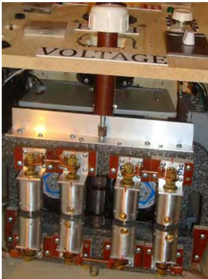
Un détail à mentionner est la pointe de chaque éclateur. Comme cette partie devient chaude, en utilisant le tungstène est raisonnable et donc le constructeur acheté en huit pièces de chaque pouce (25 mm) de long et un quart de pouce (6 mm) de diamètre. Ceux-ci ont été achetés sur eBay :
