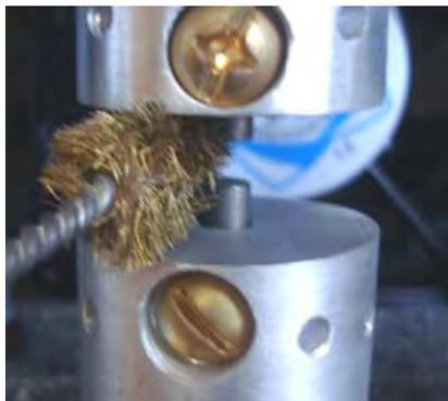
Autour des tiges de tungstène et de l'aluminium qui retient les tiges. Quand cela est terminé, j'utilise un petit fichier et déposer doucement la fin des deux barres jusqu'à ce qu'elles brillent à nouveau. Ensuite, je les souffle avec un nettoyeur d'air pour le nettoyage du clavier, à moins que l'air comprimé est disponible, et enfin, ajuster les écarts d'étincelles à la taille de l'écart souhaité.
