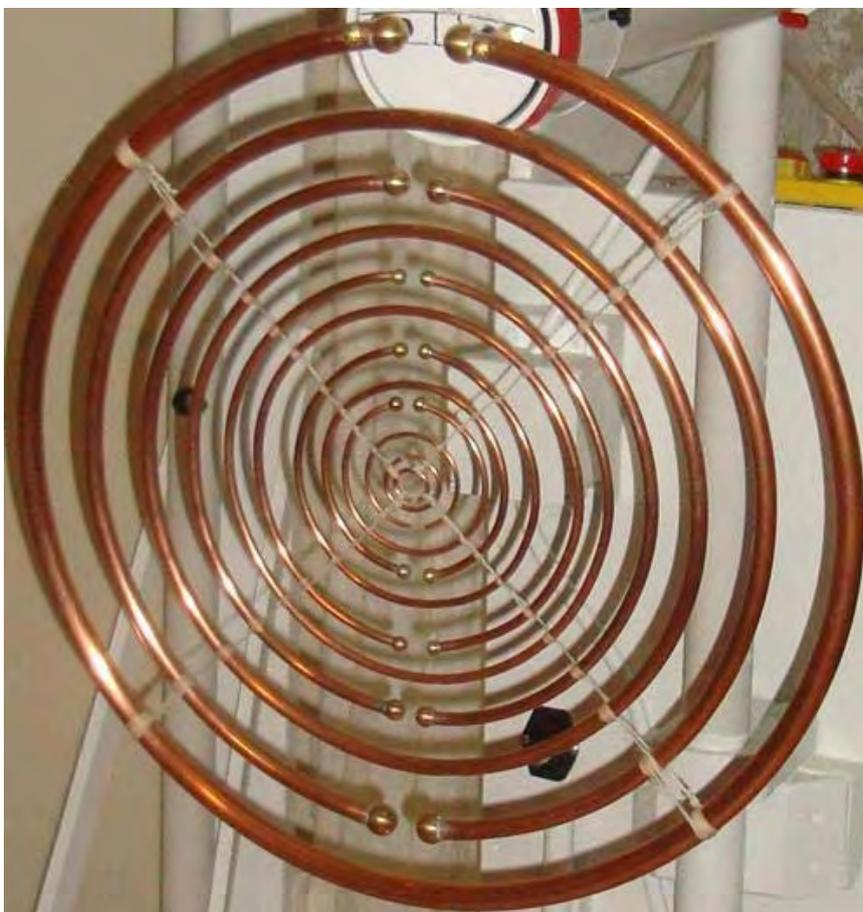
Vous remarquerez qu'il ya beaucoup de diamètres différents de tuyau de cuivre utilisés dans cette antenne et que, combiné avec le diamètre du cercle dans lequel chaque tuyau est plié, fait que chaque section de tuyau résonne avec une fréquence différente, et c'est le fonctionnement Coeur de la conception, mais plus de cela plus tard.
