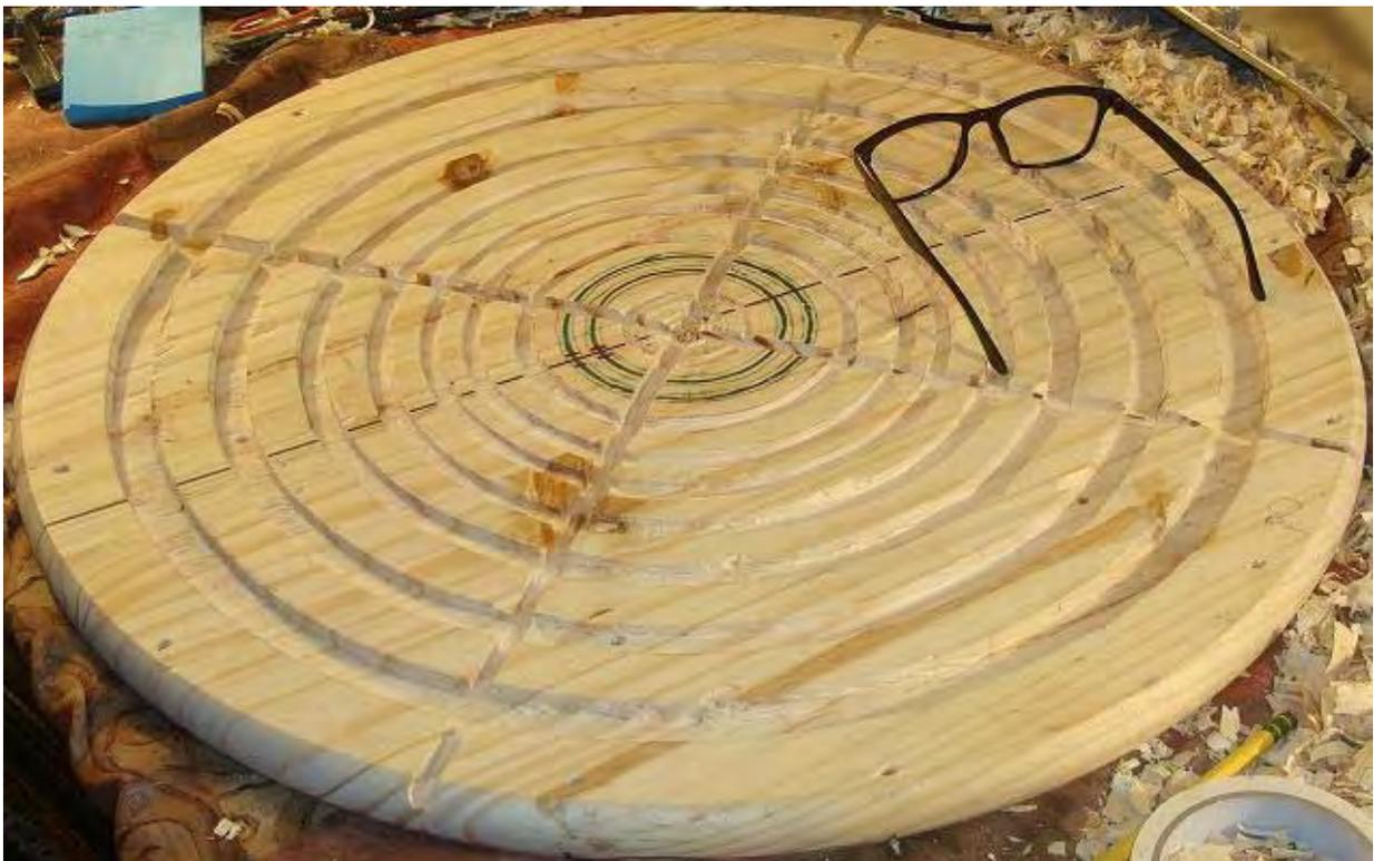
Premièrement, les positions exactes des anneaux sont repérées sur la planche. Ce sont le diamètre de l'axe de chaque tuyau, la largeur de rainure et la profondeur de rainure :
