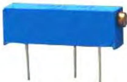
Ce style de résistance variable prédéfinie est bon marché et dispose de vingt tours de vis pour faire varier la résistance entre la broche centrale et l'autre extrémité de zéro à 200 ohms, ce qui facilite la sélection du réglage qui donne une " 15 volts " affiché lorsque la tension d'entrée est de 0,09 volts. En fait, la partie la plus difficile est d'obtenir la tension CC de 0,9 volt pour l'entrée pour obtenir le réglage correct de la résistance pré-réglée. La configuration est comme ceci :
