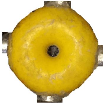
Il rotore può, naturalmente, essere costruito da materiali leggeri se è difficile ottenere un galleggiante da una rete di pesca professionale. I magneti sono magneti al neodimio di dimensioni N52 di 20 mm di spessore di 5 mm. Il motore è alimentato da una batteria agli ioni di litio da 3.7V e sono presenti otto bobine di uscita posizionate attorno al rotore. Le bobine sono collegate in coppia con le quattro coppie che alimentano il sistema.
