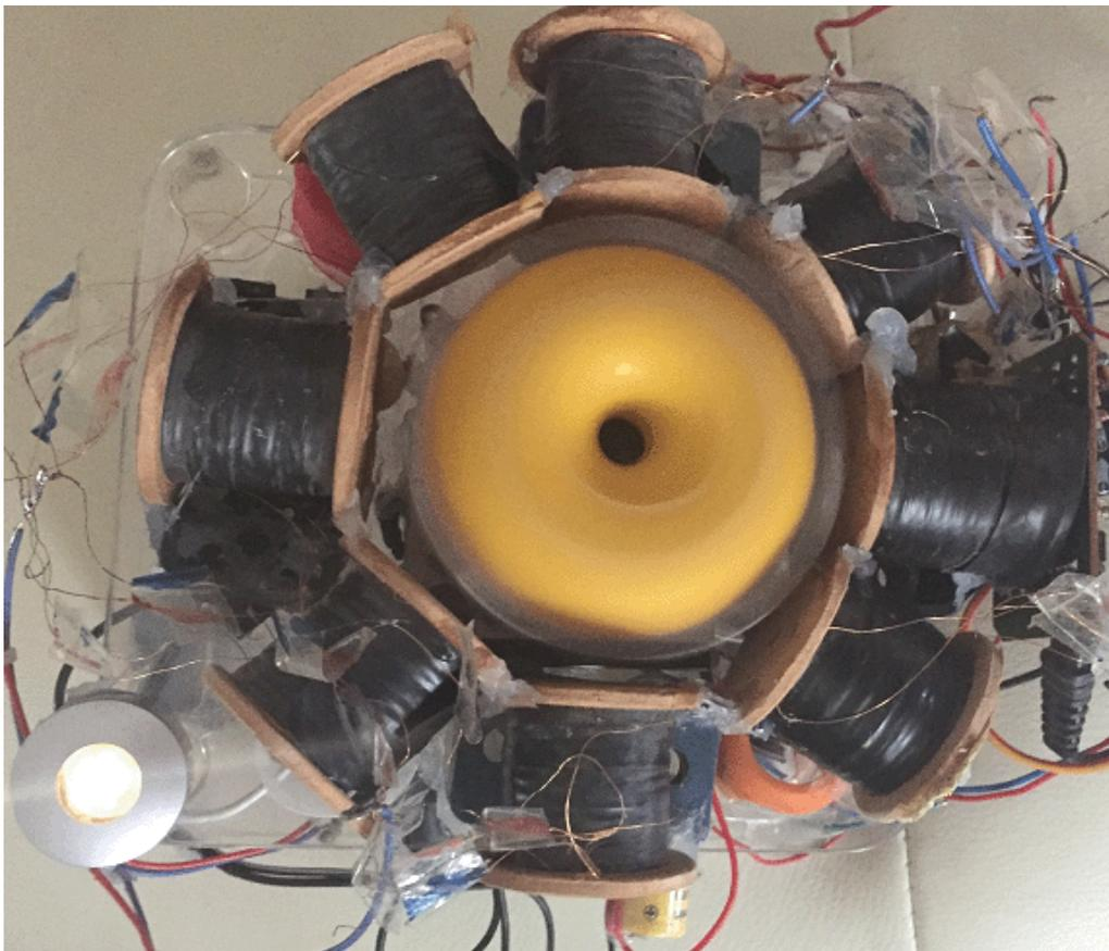
Ogni bobina è avvolta con due filamenti di filo smaltato di rame smaltato di 0,19 mm, che è swg 36 o potrebbe essere AWG # 32. Ogni filato pesa 50 grammi e entrambi i fili sono feriti
