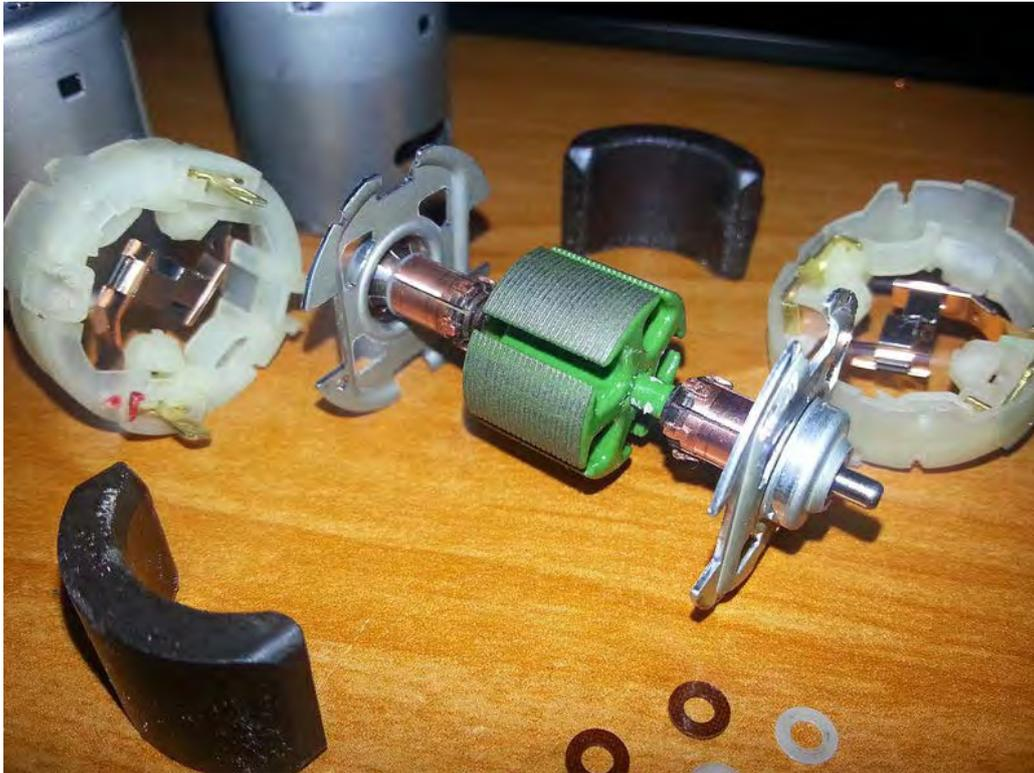
Il passo successivo è quello di collegare il filo di INIZIO e FINITURA estremità di questa forma di V doppia batteria al "collettore" anelli che permettono di corrente per essere passato attraverso la bobina proprio al momento giusto. Rivisto da una estremità dell'armatura, le connessioni sono come questo:
