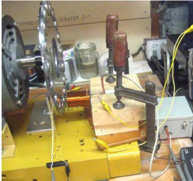
Qui, un dispositivo per misurare i campi magnetici è sensibile al campo magnetico della bobina come i magneti del rotore vanno oltre la bobina. La misurazione viene eseguita con il funzionamento della bobina normalmente e poi di nuovo, con la bobina in cortocircuito. I risultati sono mostrati in questi display dell'oscilloscopio:
