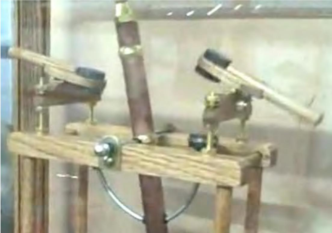
Presumibilmente, il braccio è curvato per evitare le complicazioni costruttive al perno pendolo che sarebbe causata da un braccio diritto montaggio attaccato all'albero pendolo. Il magnete aumento attaccato al pendolo spinge l'estremità magnete del bilanciere verso l'alto anche se non si avvicina ad esso.
