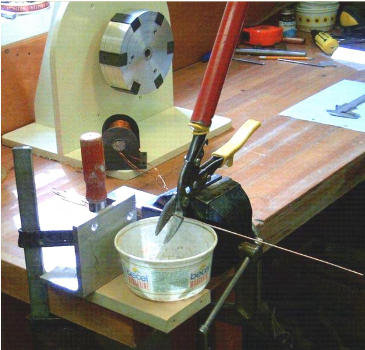
La distance entre les cisailles et l'angle du métal serrés à l'établi fait chaque longueur de la coupe de fil la dimension exigée exactement pendant que le récipient plastique rassemble les morceaux de la coupe préparé pour enduire avec gomme-laque claire ou polyurethane clair vernissez avant usage dans les coeurs de la bobine.
