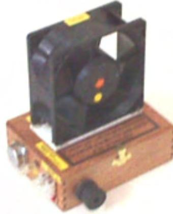
Cet appareil fonctionne avec une batterie PP3 9V comme la batterie d'entraînement, et charge une batterie PP3 9V rechargeable quand il est en marche. Les deux batteries sont enfermées dans la boîte dans cette construction très soignée.
