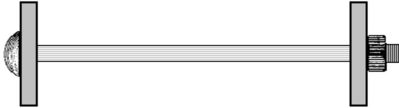
Comme la tige du boulon est conducteur, et depuis un fil de la bobine est d'être le fer non isolée, afin d'empêcher les spires de cette bobine en court-circuit à travers l'arbre central de la culasse, une mince couche de tissu est utilisé pour isoler la vis que le tissu peut absorber et retenir l'eau 'électrolyte' qui est nécessaire pour le fonctionnement de cette batterie humide.
