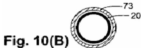
Fig.10B est un fin-vue schématique d'une bobine émettrice d'un autre mode de réalisation dans laquelle un manchon ferromagnétique est disposé coaxialement autour de la bobine émettrice.
