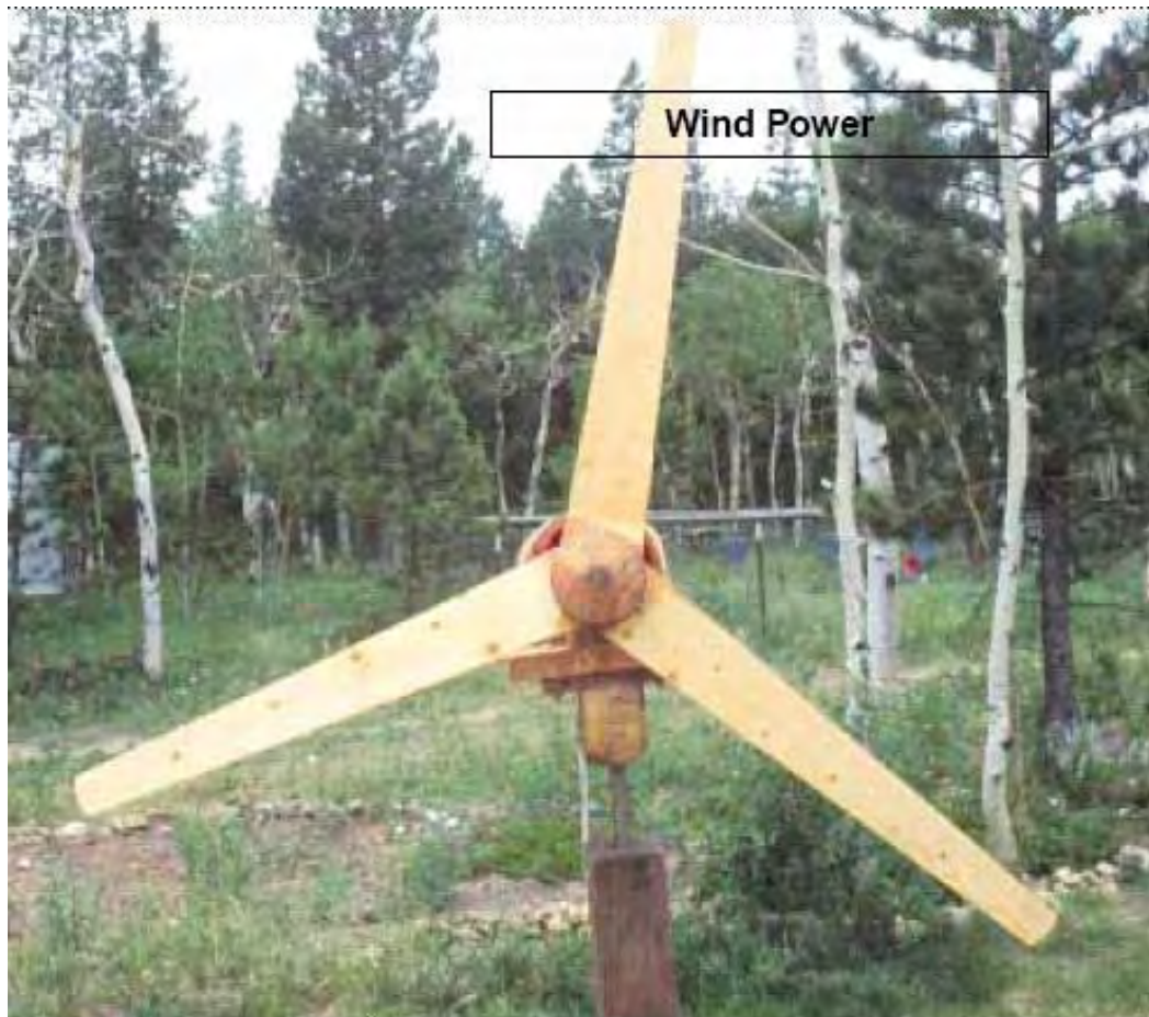
Le "Bois 103" générateur a trois pales, sculpté de main, 600 mm, la région couverte est 1.16 mètres carrés
