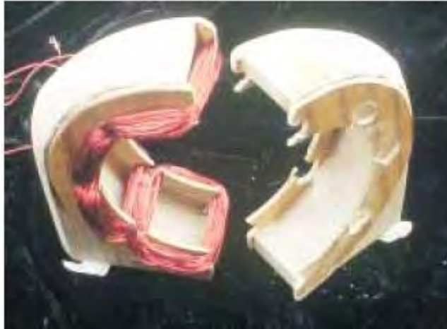
Le deux stator moitiés - une blessure avec 100 tours par bobine et une prêt pour être la blessure.
