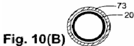
Fig.10(B) ist eine schematische Endansicht einer Sendespule eines weiteren Ausführungsbeispiels, in dem eine ferromagnetische Hülse koaxial um die Sendespule angeordnet.
